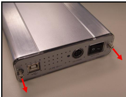
图 2. 将两颗螺丝从侧边盖板移除
