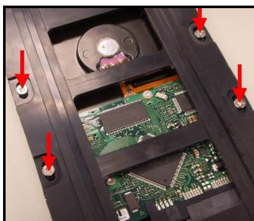
图 6. 使用附赠的螺丝将硬盘固定至塑料背板
