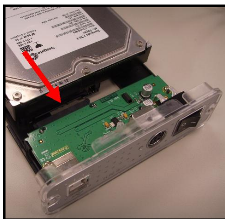
图 5. 连接 SATA 控制板至 SATA 硬盘
