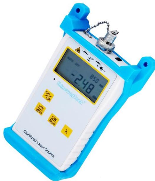
SLS-21掌上型稳定光源可提供超稳定度的光信号，并可通过LCD直接监视光源输出功率。与本公司的OPM系列光功率计配合使用，可用来识别光纤，精确测量光纤损耗和评估光纤链路传输质量。
