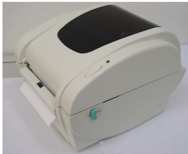
圖九 標籤安裝完成-剝紙模式
