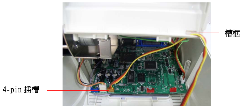
圖十四 安裝裁刀模組電纜線
