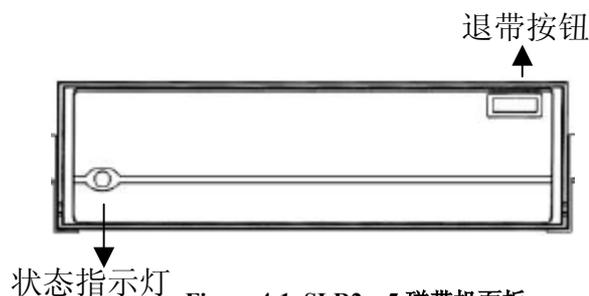
Figure 4-1. SLR2—5 磁带机面板
