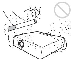
ほこりの多い場所、たばこなどの煙が入る場所での使用は避けてください。この様な場所で使用するとエアフィルターがつまりやすくなったり、故障や破損の原因となります。また、エアフィルターの汚れは内部の温度が上昇する原因になるので定期的に掃除してください。
