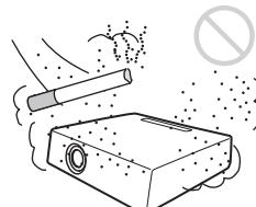
勿将本机安装在多尘或多烟雾的环境中。否则，空气滤网会被堵塞，并可能导致本机故障或损坏。灰尘会阻挡空气透过滤网，从而可能导致投影机内部温度升高。请定期清洁滤网。
