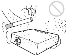
Evite instalar la unidad en un entorno en el que haya un exceso de polvo o humo. Si lo hace, el filtro de aire se obstruirá, y es posible que la unidad se averíe o no funcione correctamente. El polvo, que impide que el aire pase por el filtro, puede provocar que la temperatura interna de la unidad aumente. Limpie el filtro regularmente.
