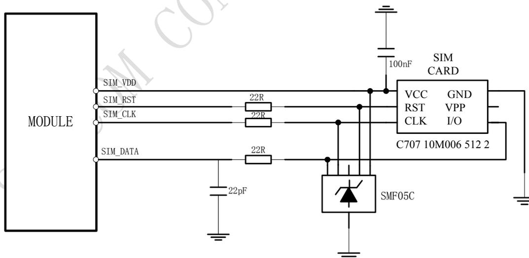
图 28: 6 引脚卡座的接口推荐电路
