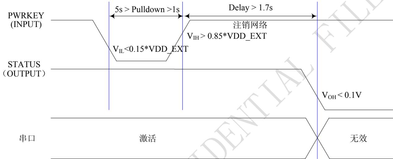
图 12: 使用 PWRKEY 引脚关机时序图
