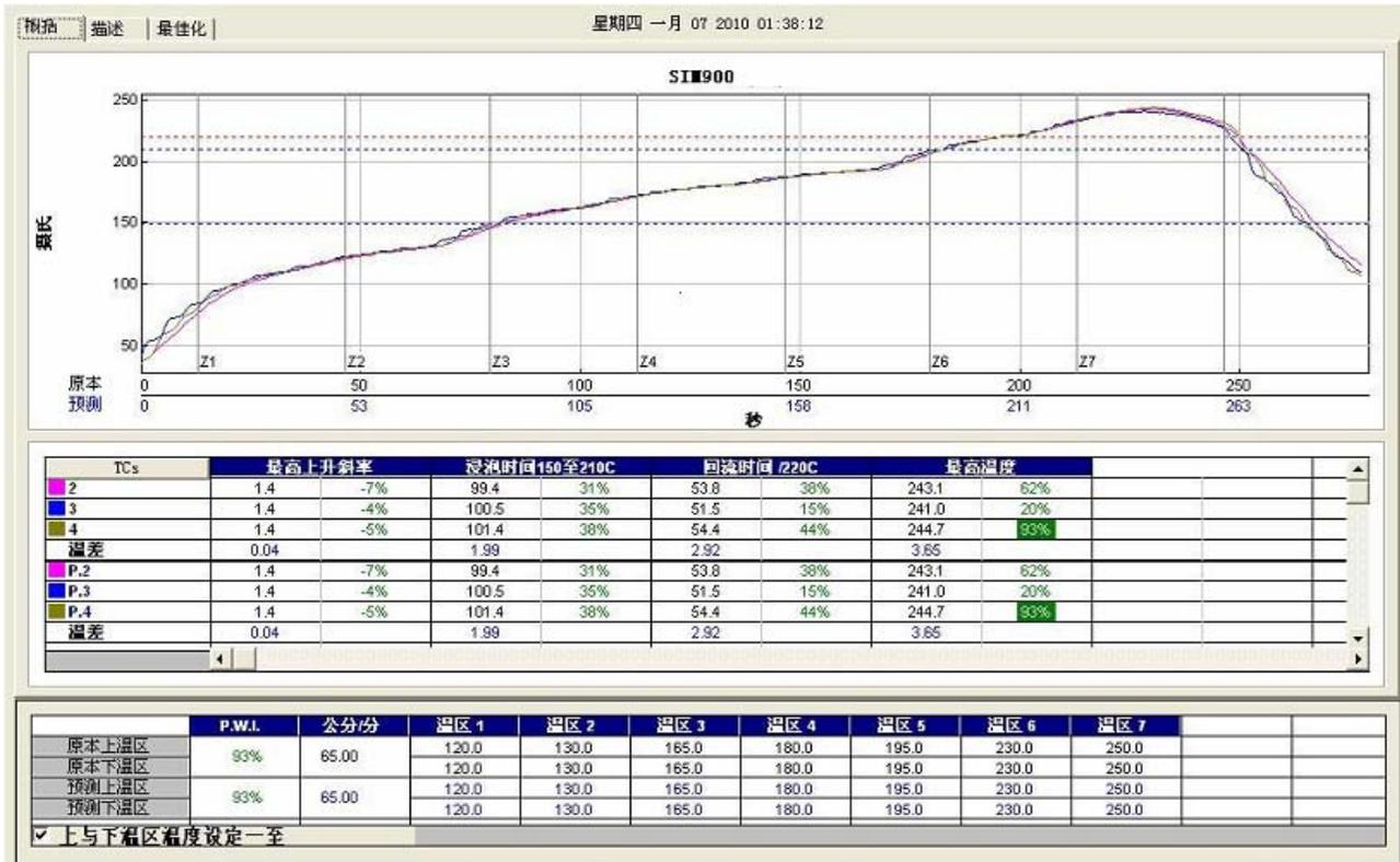
图 42: SIM900A 推荐焊接炉温曲线图
