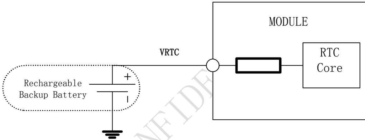
图 17: RTC 采用可充电电池供电
