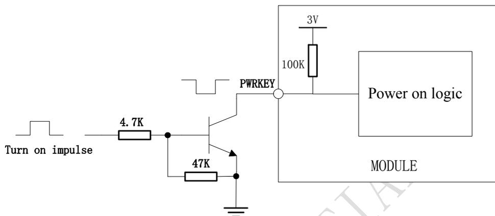
图 6: SIM900A 使用驱动电路开机
