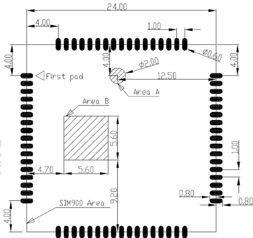
图 39: 推荐 PCB 封装图 (单位: mm)
