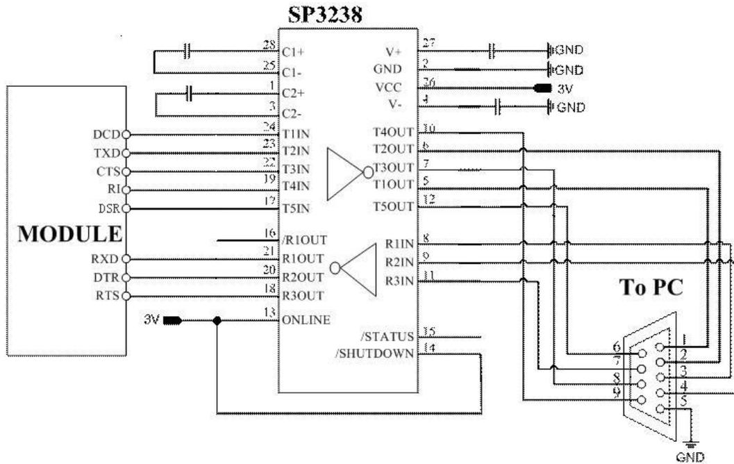
图 22: RS232 电平转换电路
