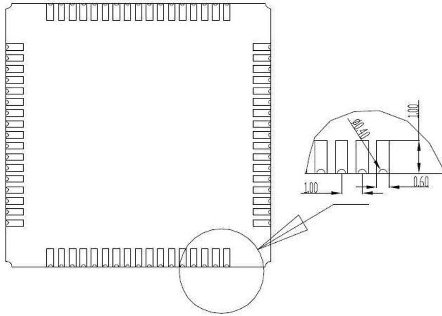
图 38: 模块底视图的物理尺寸 (单位: mm)
