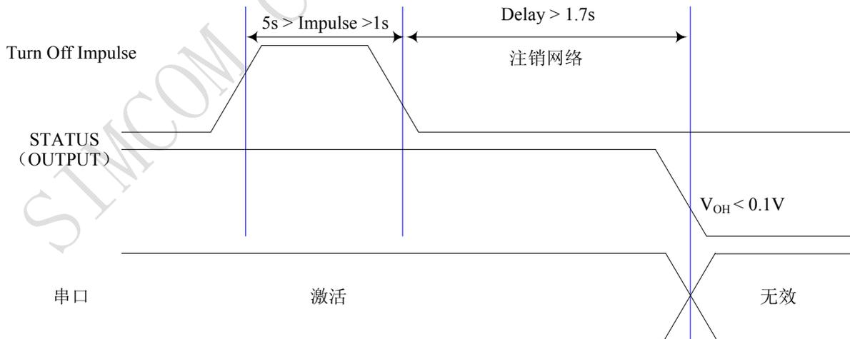
图 13: 使用 PWRKEY 和 PWRKEY\_OUT 关机时序图
