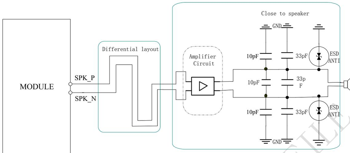
图 24: 带音频放大器的音频接口电路
