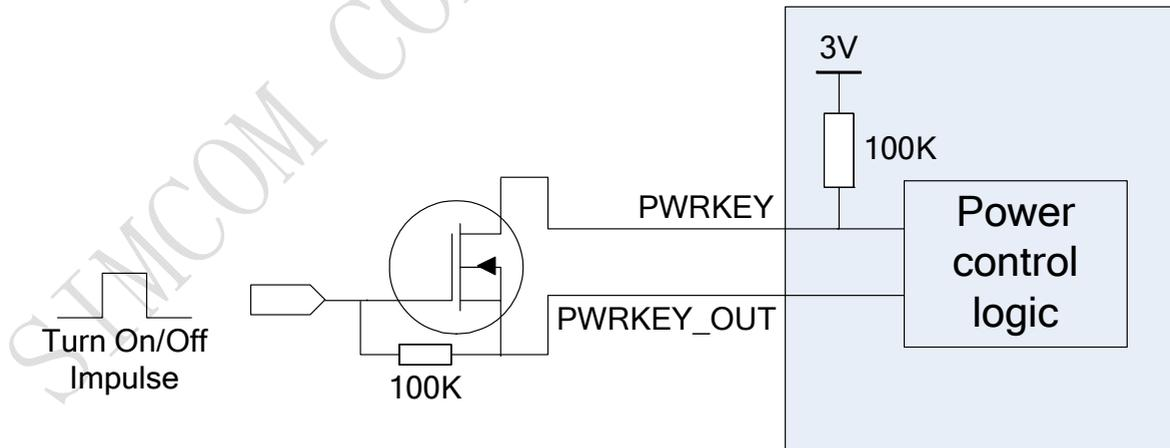
图 9: SIM900A 使用驱动电路开机
