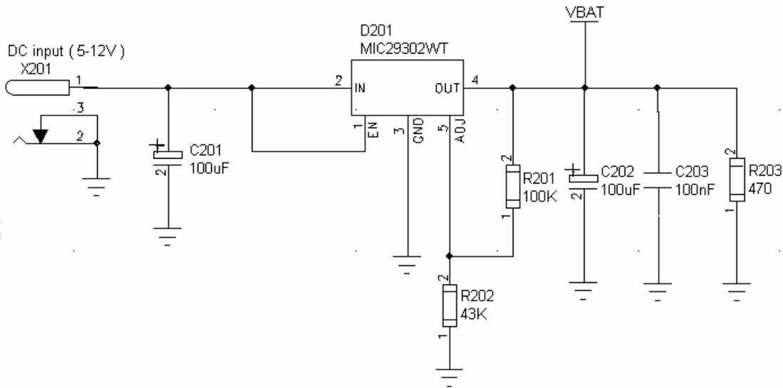
图 4: 供电输入参考设计电路
