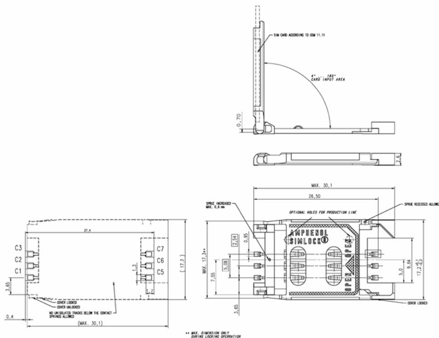
图 29: Amphenol C707 10M006 512 2 SIM 卡座尺寸图
