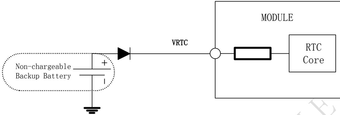
图 16: RTC 采用不可充电电池供电
