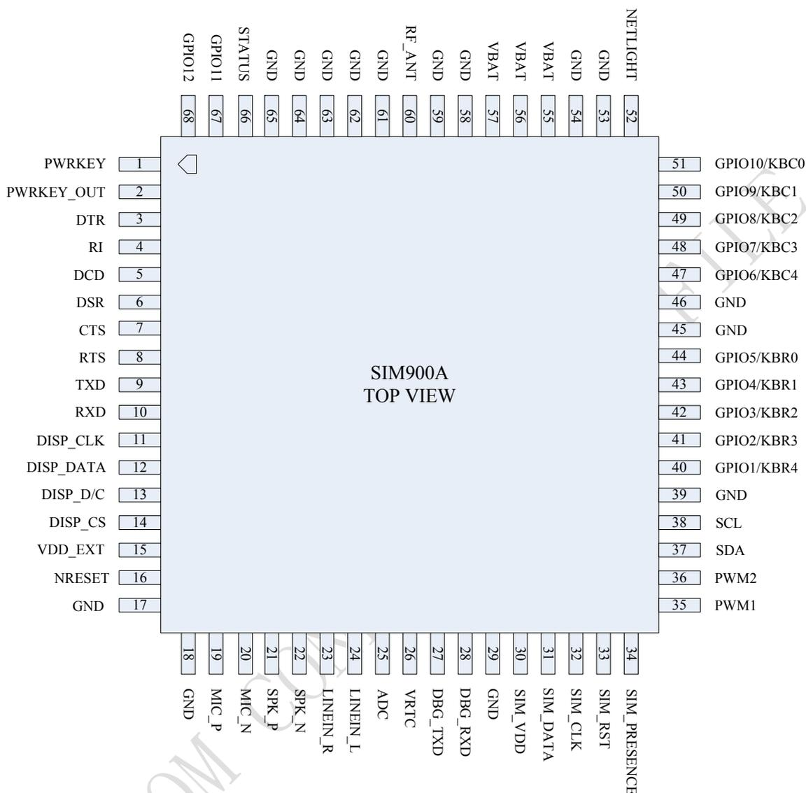
图 41: SIM900A 引脚图 (顶视图)
