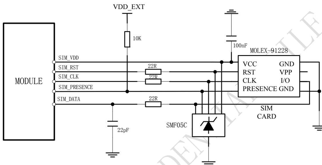
图 27: 8 引脚卡座的接口推荐电路
