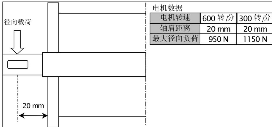
图 2-9 步进电机径向载荷
