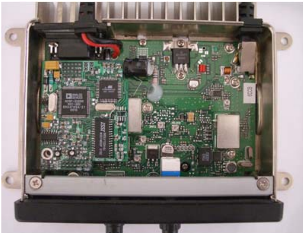
图4 ND889A-19.2K 内置 MODEM 结构
