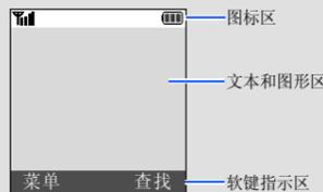
手机在屏幕最上一行显示下列状态指示图标:
