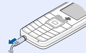
**注意:** 先拔下旅行充电器后, 再从手机取出电池。否则, 可能损坏手机。
