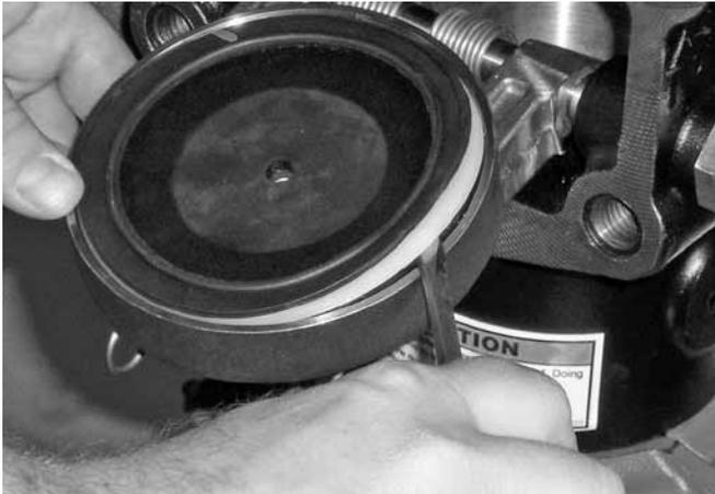
6. 將閥瓣密封連同密封環從閥瓣上撬出。檢查閥瓣密封。如果閥瓣密封撕裂或磨損，請用一個唯特利提供的新閥瓣密封更換。如果利用一個新的元件替換閥瓣密封元件，請跳至第7步。
