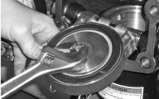
11. 擰緊密封裝配螺栓/螺栓密封墊至下表所列扭矩值，以確保達到正確的密封效果。
