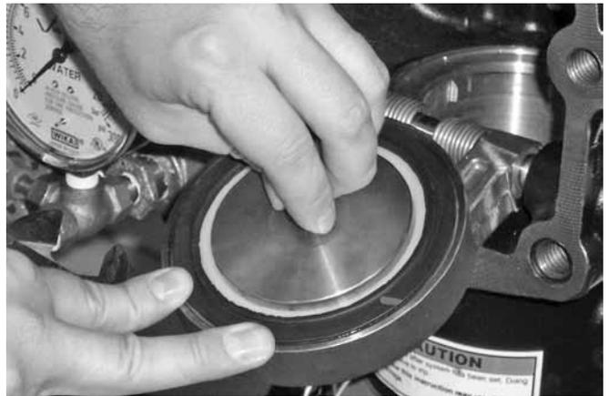
10. 將密封定位環置于閥瓣密封的密封墊片上。穿過密封定位環和閥瓣，安裝密封裝配螺栓/螺栓密封墊。
