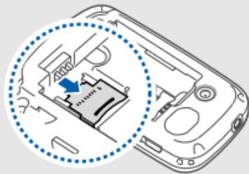
3. 拉起存储卡盖并插入存储卡，如下图所示。
