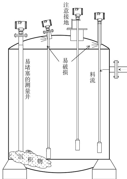
图 5 大罐安装注意事项示意图
