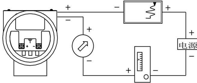
图 6 2700S 物位变送器接线图
