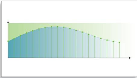
192KHz 采样使您能够准确表示原始声音曲线。与 24 位解析法配合使用, 从原始模拟声波波形捕获更多信息, 从而产生更丰富的音频再现效果。
