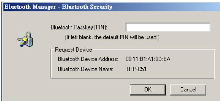
**第 10 步：**成功連接 ODR-C51 時用戶可以看到下面的畫面，LINK LED 停止快速閃爍而變為亮燈。ODR-C51 可以進行資料通信或控制。用戶還可以發現 ODR-C51 已被追加到系統設備管理之中。
