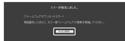
以下のような画面が表示された場合は、画面の指示にしたがって再起動後に「状態表示」画面にてバージョンを確認してください。(詳細取扱説明書「状態表示」画面)
