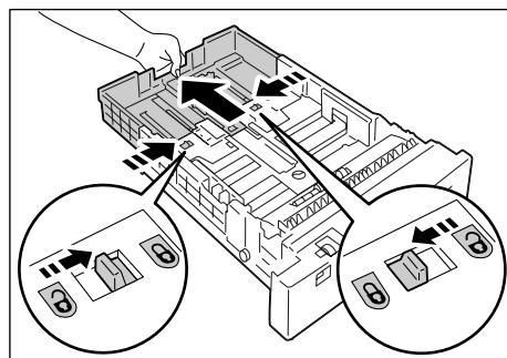
4. 左の用紙ガイドクリップを指でつまみ、用紙のサイズまで動かします。（例：A4 サイズを横置きにする場合）
