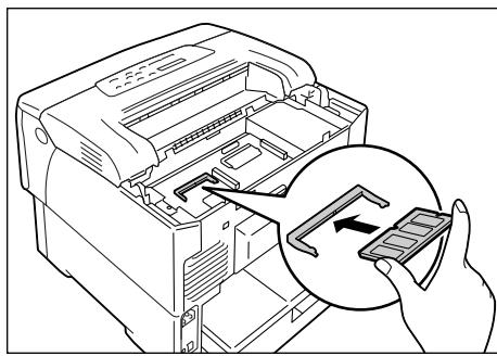
10. 増設メモリを図のように上から押します。正しく挿入されると、カチッという音がします。
