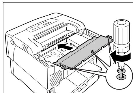
10. 後部カバーを戻し、2 か所のネジをドライバーで締めて固定します。
