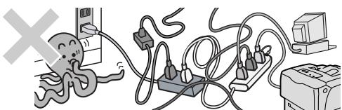
添付の電源コードのみでは届かないところには設置しないでください。コンセントに定格以上の電流が流れると、コンセントが過熱して火災の原因となるおそれがあります。
