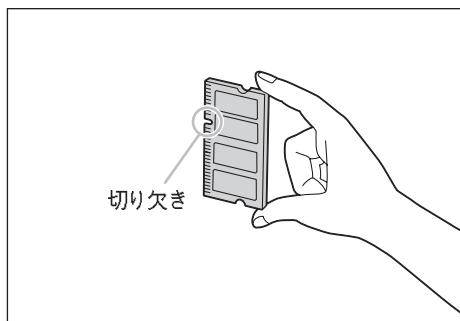
8. 新たに取り付ける増設メモリを切り欠き部分が中央よりも上側にくるように持ちます。
