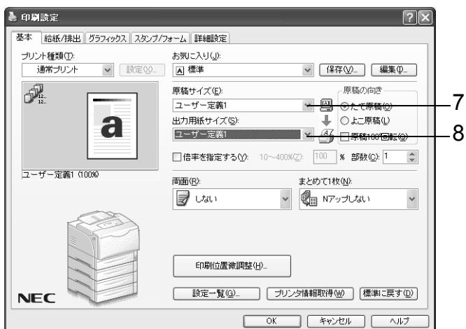
8. [出力用紙サイズ] から、登録したユーザー定義サイズの用紙を選択し、[OK] をクリックします。
