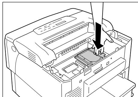
8. 付属の2本のネジをドライバーで締めて、外側からハードディスクを固定します。
