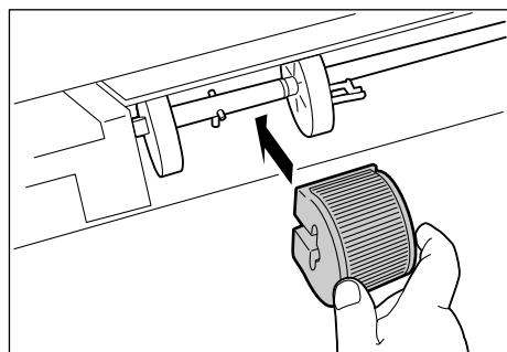
8. ローラの凹部に軸のピンがはまるように、ローラを奥側に90°回転させ、左にずらします。
