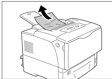
2. トップカバーの内部に用紙があるときは、本体の左右側面にあるフロントカバー開閉レバーを引きながら、フロントカバーを開け、トップカバーを開けます。
