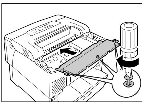
13. 後部カバーを戻し、2 か所のネジをドライバーで締めて固定します。
