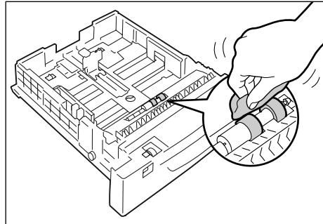
3. 続けて、プリンター側のローラも清掃します。用紙カセットを引き抜いた箇所の上側を覗き込み、オレンジ色のローラが 2 本あることを確認してください。
