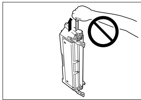
8. 図のように、EP カートリッジをプリンター正面に向けて、EP カートリッジの取っ手を持ち、EP カートリッジの両側の突起部をプリンターの内側の溝に合わせて、スライドさせてセットします。
