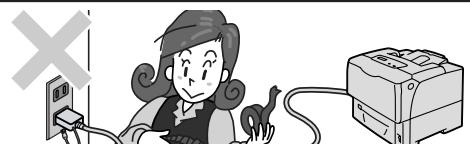
電源コードが破損した場合は、ビニールテープなどで補修して使用しないでください。補修した部分が過熱し、火災や感電の原因となるおそれがあります。損傷したときは、すぐに同じ電源コードに取り替えてください。
