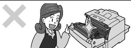
このプリンターはレーザー（レーザーダイオード）を使用しています。電源がONになっているときに内部をのぞいたり、鏡などを差し込んだりしないでください。万一、レーザー光が目に入ると失明するおそれがあります（レーザー光は目に見えません）。
