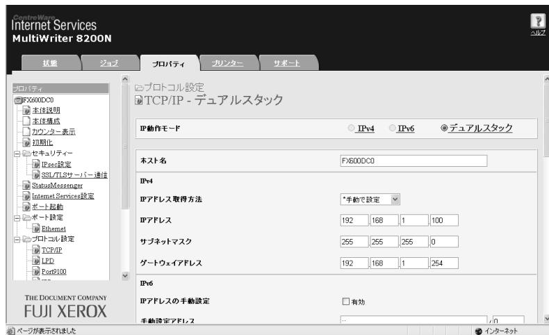
工場出荷時は、[IP 動作モード] が [デュアル スタック] に設定されています。[IPv4] に設定されている場合は、お使いのネットワーク環境に応じて、[デュアル スタック] または [IPv6] に設定します。
