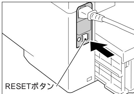
また、1ヶ月に1度は機械の電源スイッチを切り、漏電ブレーカーが正常に働くか確認してください。正常に動作しない場合、感電のおそれがあります。
