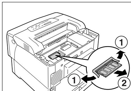
7. すでに増設メモリが取り付けられている場合は、メモリーを固定している左右のツメを広げます。メモリーが斜めに持ち上がるるので、そのまま斜め方向に引き抜きます。
