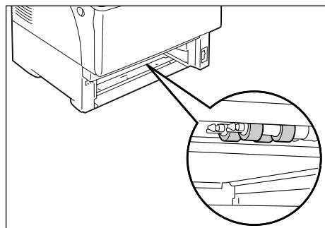
4. 手前のローラのツメを広げてロックを外し、軸から引き抜きます。
