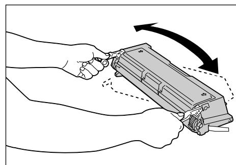
7. EP カートリッジの取っ手を手前にして、机など水平な面に置いて、側面から出ているトナーシールの端を持ち、ゆっくり引き抜きます。
