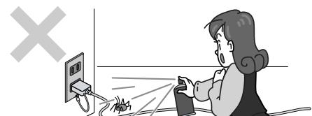
電源コードに殺虫剤などの薬品類をかけないでください。コードの被覆が劣化し、感電や火災の原因となることがあります。
