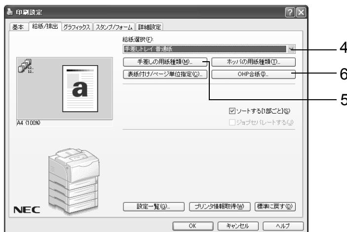
OHP フィルムをホッパ 1 ~ 4 にセットした場合は、[給紙選択] からセットしたホッパを選択するか、[給紙選択] は [自動] のままで [ホッパの用紙種類] ダイアログボックスを表示し、[OHP フィルム] を選択します。
