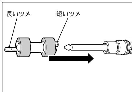
8. ローラの短いツメを軸の溝に合わせて、しっかり奥まで押し込みます。
