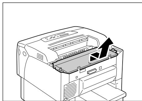
6. マルチプロトコル LAN カードを取り付けている場合は、いったん取り外します。手順の詳細は、マルチプロトコル LAN カードの設置手順書を参照してください。
