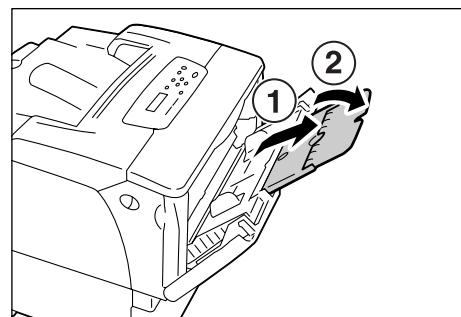
3. 印刷する面を下にして、用紙をセットします。
