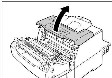
6. 水でぬらし固く絞った柔らかい布で、ローラを回転させながら、ゴム製の部分をふきます。
