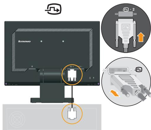
4. 将显示器电源线和计算机线插接到接地的电源插座。
