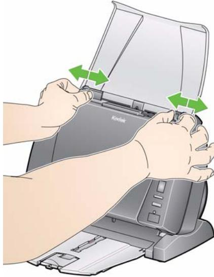
4. 調整輸入托盤。如果您使用的是 PS410 掃描機，則可在輸入托盤打開或合上的情況下掃描相片。若您要掃描成批相片，請在輸入托盤打開的情況下送入相片。
