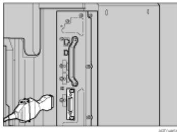
3. パソコンのインターフェースコネクタにインターフェースケーブルのもう一方のコネクタを接続し、固定します。
