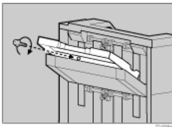
25. 両面ユニットに取り付けられているプリンター本体の排紙トレイを元に戻します。先端部分を起こします。
