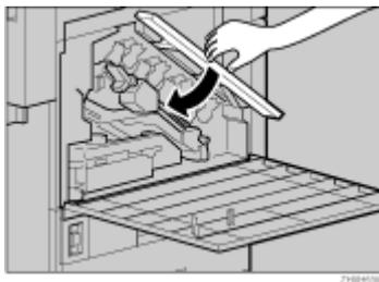
12. 専用ねじ回しを使って、上から順番にネジを2箇所時計回りに回して締めます。
