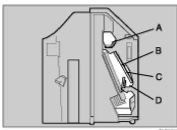
6. 2000 枚フィニッシャー内部の A を確認し、つまった用紙があったら取り除きます。レバーを引き上げ、下りないように手で押さえながら、つまった用紙をゆっくりと引き抜きます。
