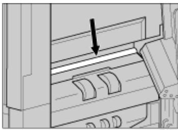
3. 水でぬらし、固く絞った布でレジストローラーを左右に動かして回しながら拭きます。
