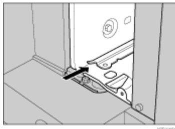
9. 専用ねじ回しを使ってねじを時計回りに回して4本締め、コントローラーボードを固定します。ねじは、コントローラーボードのねじ穴のそばに書かれている1から4までの数字の順番に締めます。
