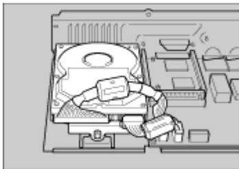
9. コントローラーボードを上下のレールに合わせて、「PUSH」と書かれている部分を押し、突き当たるまでゆっくりと押し込みます。
