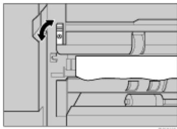
3. プリンター本体の右下カバーに貼られている「PUSH」の部分を押して、右下カバーを閉めます。
