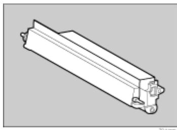
9. 現像ユニットの矢印を本体内部の右側のレールの上に載せ、左側のレールに沿って、ゆっくりと奥まで差し込みます。
