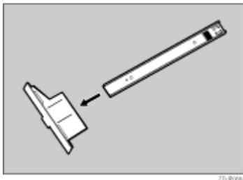
8. プリンター本体の左側面向かって右下にある穴に、同梱されている長いねじ1本を仮留めします。手で3、4回転させます。
