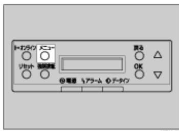
2. [▲] (上三角) または [▼] (下三角) キーを押して、「システムセッテイ (EM)」を表示させ、[OK] キーを押します。
