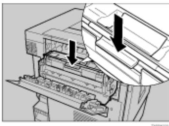
8. 片手で定着ユニットの取っ手を持ち、もう一方の手で定着オイルユニットを水平に手前に引いて取り外します。取り外した定着オイルユニットは、新しい定着オイルユニットに同梱されているチャック付きの袋に入れて、封をします。
