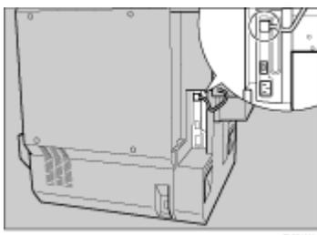
これで両面反転ユニットが取り付けが完了しました。排紙トレイを取り付けた後に、両面搬送ユニットを取り付けます。
