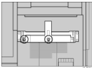
15. 専用ねじ回しを使って、長いねじで接続金具の右側を時計回りに回して留めます。前の手順で仮留めした2本のねじも最後まで締めます。
