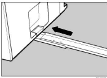
18. 専用ねじ回しを使って、長いねじで時計回りに回してレールを固定します。
