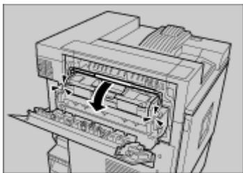
16. プリンター本体の左上カバーを閉め、下部の取っ手横に貼られている「PUSH」の部分を押して、ガチッと音がするまで押し込みます。
