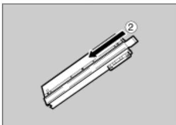
4. 図のように定着オイルユニットを持ち、もう一方の手で定着ユニットの緑色の取っ手を押さえて、矢印の方向にゆっくりと奥まで水平に差し込みます。
