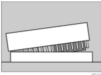
9. コントローラーボードを上下のレールに合わせて、「PUSH」と書かれている部分を押し、突き当たるまでゆっくりと押し込みます。
