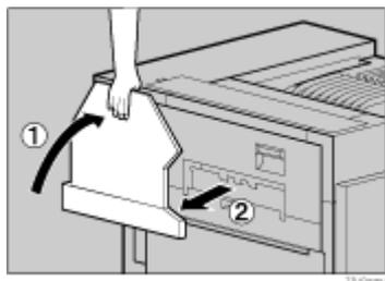
6. プリンター本体の左上カバーについている小さいカバーを2個取り外します。プリンター本体の左上カバー上部の取っ手を持ち、ゆっくりと開けます。
