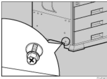
9. 前の手順で固定金具に差し込んだレールを、プリンター本体の左側面底部中央に差し込みます。
