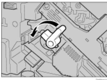
4. 専用ねじ回しを使って、中カバーを固定している 2 箇所のねじを反時計回りに回して最後までゆるめます。
