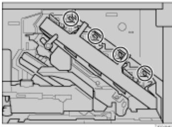
3. 掃除棒を抜き差しして 4 箇所すべて清掃します。8 から 10 回くらい、ゆっくりと奥まで突き当てるように抜き差ししてください。
