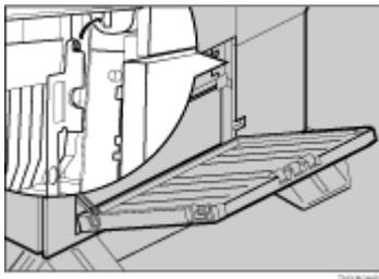
10. 取付金具下部にある穴に、つまみねじ（1本）を使って、取り付け金具を固定します。コインを使って、しっかり固定してください。
