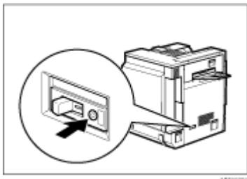
5. ブレーカーのスイッチが「Off」側（○）へ倒れることを確認します。
