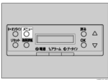
2. [▲] (上三角) または [▼] (下三角) キーを押して、「システムセッテイ」を表示させ、[OK] キーを押します。
