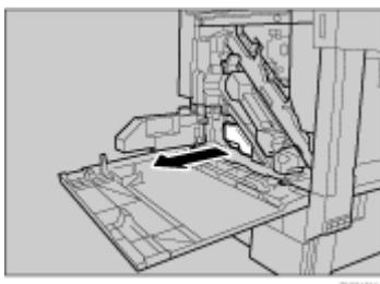
6. 取り出した廃トナーボトルのふたを取り外して、図の位置に付け替えます。
