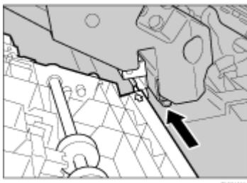
4. 専用ねじ回しを使って、短いねじ 1 本で両面搬送ユニットを固定します。
