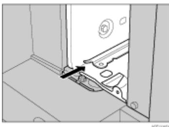
10. 専用ねじ回しを使ってねじを時計回りに回して4本締め、コントローラーボードを固定します。ねじは、コントローラーボードのねじ穴のそばに書かれている1から4までの数字の順番に締めます。
