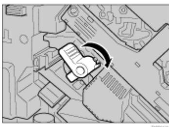
11. 現像ユニットから出ているテープを、中カバーを押さえながら水平にゆっくりと引き抜きます。
