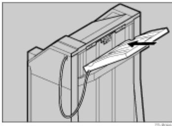
24. 専用ねじ回しを使って、短いねじを時計回りに回して排紙トレイを固定します。
