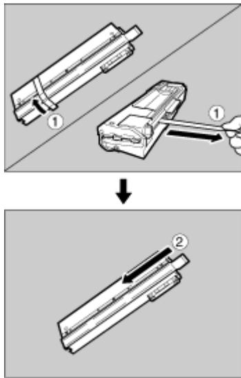
10. 図のように定着オイルユニットを持ち、もう一方の手で定着ユニットの緑色の取っ手を押さえて、矢印の方向にゆっくりと奥まで水平に差し込みます。
