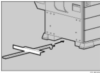
10. 前の手順で仮留めしたねじに、固定金具の穴を引っ掛けます。
