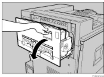
7. 図の矢印の位置にあるレバーを軽く押し下げて、定着オイルユニットを固定している取っ手を外します。
