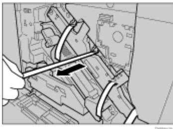
12. 赤い札のついた転写ユニットの固定ピンを取り外します。つまんで引き抜きます。固定ピンは図の位置にセットされています。
