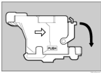
6. カートリッジを斜めに差し込み、カチッと音がするまで押し込みます。
