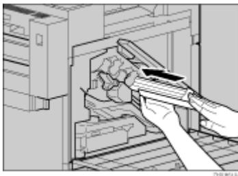
感光体ユニット先端の緑色の矢印がプリンター内部のレールにきちんと合っていないまま差し込むと、感光体ユニットが傷つきます。
