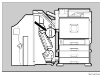
**2. パンチくず箱をゆっくりと引き抜き、パンチくずを廃棄します。**
