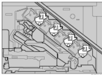
6. 交換する現像ユニットを取り外します。交換する現像ユニットのレバーに指を掛けて、ゆっくりと半分まで引き出します。
