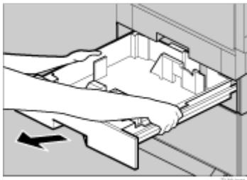
6. 給紙トレイ 2 (標準) の入口左側にある穴に、つまみねじ (1 本) を使って固定します。コインを使って、しっかり固定してください。
