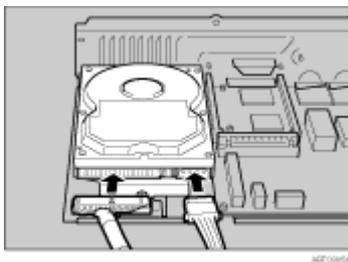
8. コントローラーボードにコネクタと電源ケーブルを接続します。
