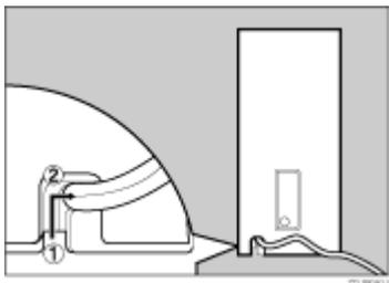
14. 4ピンプリントポストのケーブルを、プリンター本体背面の下段のコネクターに接続します。
