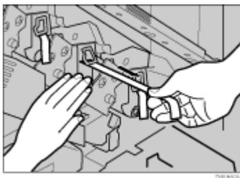
テープは必ず引き抜いてください。テープを引き抜かないで動作させると、故障の原因になります。
