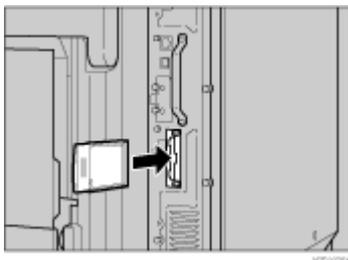
8. 静電気防止カバーの両角が切り込まれている方を手前にして、静電防止カバーをカードに取り付けます。
