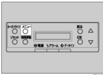
5. [▲] (上三角) または [▼] (下三角) キーを押して「ヨウシセッテイ」を表示させ、[OK] キーを押します。
