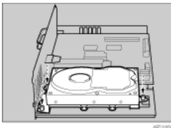
7. 拡張 HDD に電源ケーブルとコネクタを接続します。
