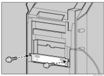
17. 2000枚フィニッシャーのレールにプリンター本体のレールを載せ、突き当たるまで差し込みます。
