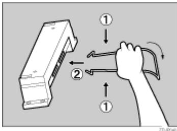
11. 受け台の両端部分についているツメのある方を上にしてプリンター本体の左側面にある穴に差し、下へ押しします。
