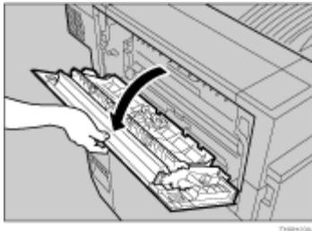
7. 2個のカバーの端にあるツメをつまんで、矢印の方向に押し取り外します。
