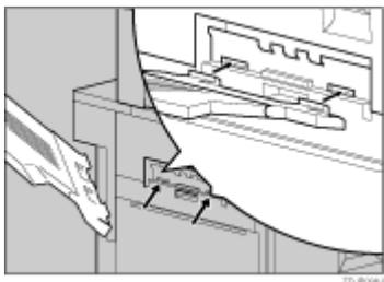
12. 4ピンプリントポストのケーブルの固定テープを取り外します。
