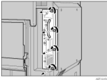
取り外したねじは、コントローラーボードを固定するときに使用します。
