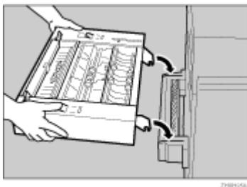
両面反転ユニットのフックが、受け台の溝の中にあるバーにかみ合います。
