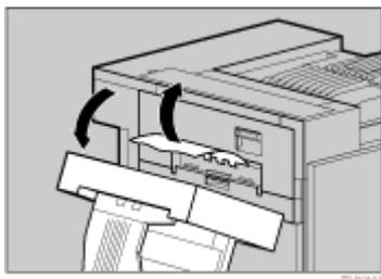
5. 両面反転ユニットをゆっくりと起こしてカチッと音がするまで押し込みます。左カバーをを起こし、「PUSH」シールの部分を押し込んでしっかり閉めます。
