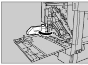
3. 両面搬送ユニットを両手で持ち、下のレールに載せてゆっくりと奥に突き当たるまで差し込みます。
