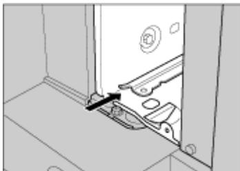
10. 専用ねじ回しを使ってねじを時計回りに回して4本締め、コントローラーボードを固定します。ねじは、コントローラーボードのねじ穴のそばに書かれている1から4までの数字の順番に締めます。
