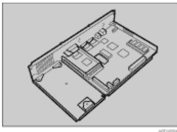
8. アカウント拡張モジュールの三角マークとコントローラーボードの矢印の向きを合わせて、差し込みます。
