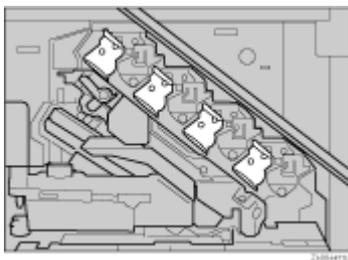
6. 交換する感光体ユニットを取り外します。感光体ユニットの右上部分にある緑色のフックを、図のようにゆっくりと右に倒します。
