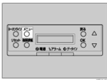
2. [▲] (上三角) キー、[▼] (下三角) キーを押して「チョウセイ/カンリ」を表示させ、[OK] キーを押します。
