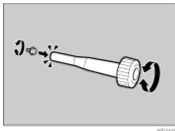
ねじを専用ねじ回しに押し込むと、ねじを落とさずに作業することができます。
