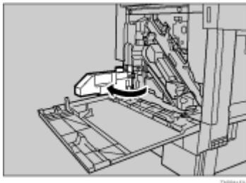
4. 専用ねじ回しを使って、両面搬送ユニットを固定しているねじを1本外します。
