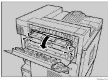
12. プリンター本体の左上カバーを閉め、下部の取っ手横に貼られている「PUSH」の部分を押して、ガチッと音がするまで押し込みます。
