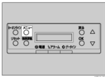
2. [▲] (上三角) または [▼] (下三角) キーを押して「ヨウシセッテイ」を表示させ、[OK] キーを押します。
