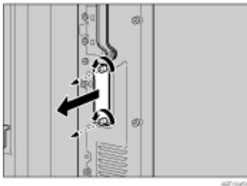
5. インターフェースユニットを奥まで差し込み、ねじ 2 個を締めて固定します。
