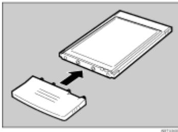
7. 黒いアンテナ部分に凹凸のある方を手前にして、ゆっくりと突き当たるまでインターフェースユニットにカードを差し込みます。
