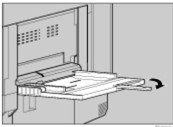
2. サイドガイドを広げ、印刷する面を上にして、用紙を先端が突き当たるまで差し込みます。
