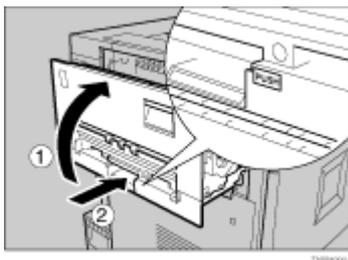
7. 排紙トレイをプリンター本体に取り付けます。排紙トレイのフックを本体のスリットに差し込み、ゆっくりと倒します。
