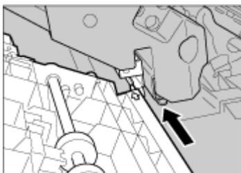
10. 専用ねじ回しを使って、前の手順で外したねじで、両面搬送ユニットを固定します。
