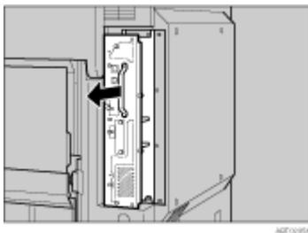
6. 専用ねじ回しを使って 3 本のねじを締め、コントローラーボードと拡張 HDD を固定します。
