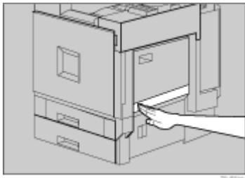
5. 電源プラグをコンセントに差し込み、本機の電源を入れます。
