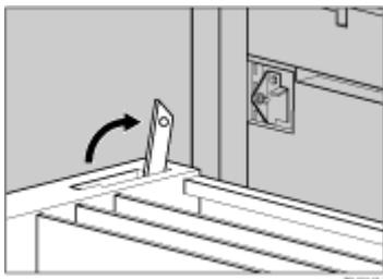
4. 補助バーの穴をプリンター本体側の取り付け金具に引っ掛け、取り付け金具突起部中央まで移動させます。
