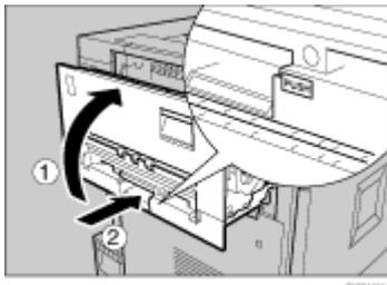
13. 前の手順で排紙トレイを外した場合は、プリンター本体に取り付けます。排紙トレイのフックを本体のスリットに差し込み、ゆっくりと倒します。
