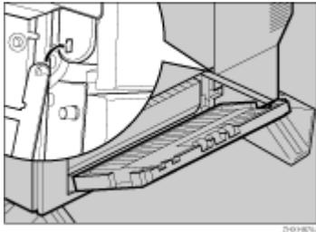
12. 取付金具下部にある穴に、つまみねじ（1本）を使って、取り付け金具を固定します。コインを使って、しっかり固定してください。
