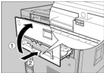
17. 前の手順で排紙トレイを外した場合は、プリンター本体に取り付けます。排紙トレイのフックを本体のスリットに差し込み、ゆっくりと倒します。
