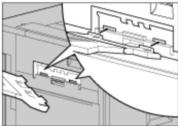
18. 両面印刷ユニットを取り付けているときは、両面反転ユニットを閉じます。
