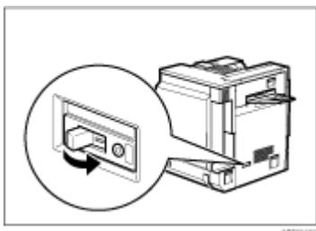
6. 漏電ブレーカーのスイッチを「On」側（「I」側）へ戻します。
