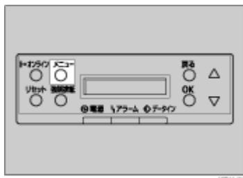
2. [▲] (上三角) または [▼] (下三角) キーを押して、「PS セッテイ」を表示させ、[OK] キーを押します。
