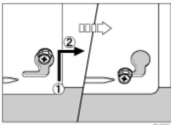
12. 固定金具の左角とプリンター本体の矢印を合わせ、専用ねじ回しを使って、同梱されている長いねじで固定金具の左側を時計回りに回して留めます。前の手順で仮留めした右側のねじも最後まで締めます。
