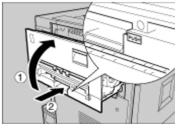
8. 前の手順で排紙トレイを外した場合は、プリンター本体に取り付けます。排紙トレイのフックを本体のスリットに差し込み、ゆっくり倒します。
