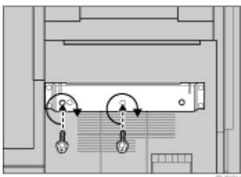
14. 接続金具の水平な方を下にして、前の手順で仮留めしたねじに引っ掛けます。
