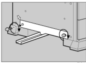
13. 両面反転ユニットの図の位置に、同梱されている長いねじ 2 本を仮留めします。手で時計回りに 3、4 回転させます。
