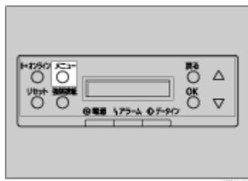
2. [▲] (上三角) または [▼] (下三角) キーを押して、「インターフェースセッテイ」を表示させ、[OK] キーを押します。
