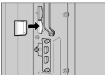
5. 拡張エミュレーションカード取り付け部のカバーを取り付けます。ねじ2個を締めて固定してください。
