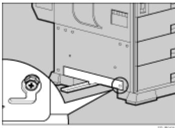
11. 両手で固定金具を持ち、上、右の方向に動かしてセットします。
