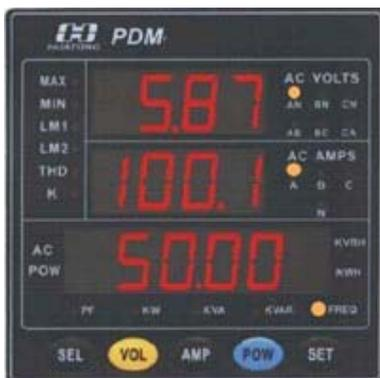
第三屏：按“SEL”键 2 次，需量 LED 灯“最小”亮。此时仪表电压窗口显示 C 相电压的最小值。
