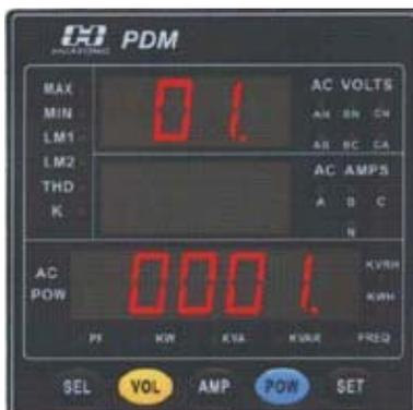
第二屏：按“SEL”键直到功能码 01 显示在最上行；最下行显示当前通讯地址的设定值。
