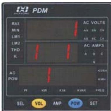
第四屏：。如果选择密码正确，仪表按左图所示；并将负向“有功电能”表底值清零。
