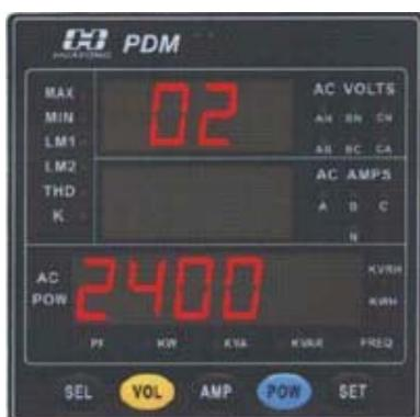
第四屏：重复步骤三直到新的波特率输入完成当全部完成时，中间行显示空白，并且最下行显示当前设定新的波特率值。
