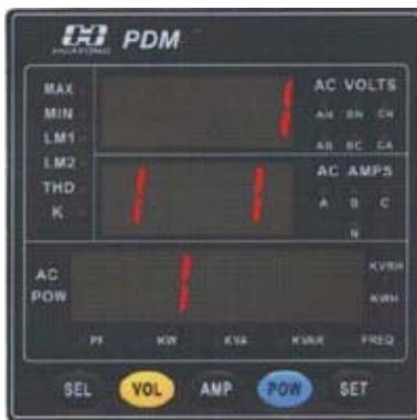
第四屏：如果选择密码正确，仪表按左图所示；并将“无功电能”表底值清零。
