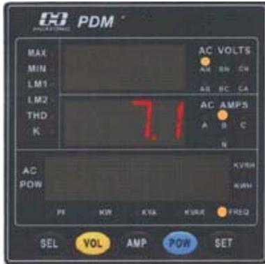
第三屏：按“AMP”或“VOL”键，此时仪表“AC AMPS”或“AC VOLTS”窗口显示该电量对应的“谐波分量”。
