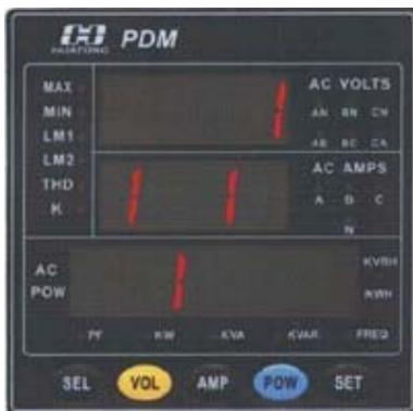
第三屏：按“SET”键，此时仪表显示上图状态，并将正向功率因数的最大值清零。
