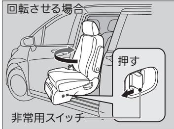
9. 回転昇降スイッチの横にあるラベルをはがし、シートが車体に接触しないように前後左右を確認しながら、下記スイッチ操作を交互に繰り返して「ピッ」とブザーが鳴る位置までシートを格納（後ろに下げる）する。
