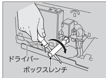
6. ボックスレンチにドライバーを奥まで差し込み、昇降モーター回転軸が回らなくなるまで矢印の方向に回す。
