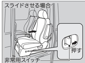
6. シートが接触しないように前後左右を確認しながら、下記のスイッチ操作を交互に繰り返して「ピッ」とブザーが鳴る位置までシートを格納（後ろに下げる）する。
