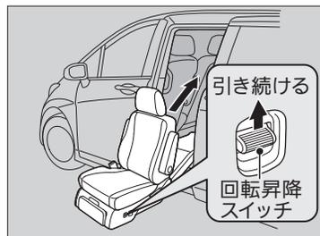
3. 回転昇降スイッチを上を引き続けて、シートが止まるまで上昇させる。
