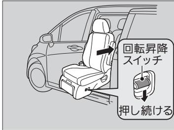
4. 回転昇降スイッチを下に押し続けて、シートが止まるまで車内側へ引き込む。
