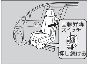
8. 回転昇降スイッチを下に押し続けて、シートが止まるまで車内側へ引き込む。
