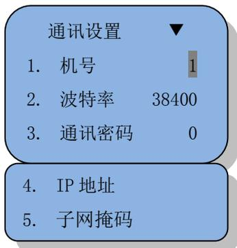
系统设置共有 5 个三级菜单：机号、波特率、通讯密码、IP 地址、子网掩码：
