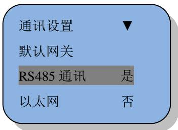
**注：**机号、波特率和串口号都必须与管理主机中的设置一致。另：RS485 数据转换器不在标准配置中。
