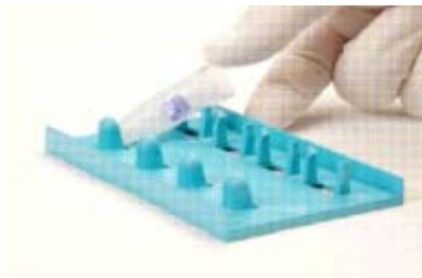
图1：在支架上放置Midi型EZ-Tube透析管示意图。透析管两侧的膜必须与电泳区垂直以保证电流可以通过透析管。
