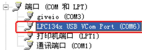
此时, 除了 PC 机默认的 COM1 还有一个虚拟串口 COMx(x 和 PC 机当前已配置串口数有关)。通过串口工具, 将串口 0 和串口 x 都打开。此时向其中一个串口输入窗口中输入字符串, 对应字符串将会在另外一个串口窗口中显示。
