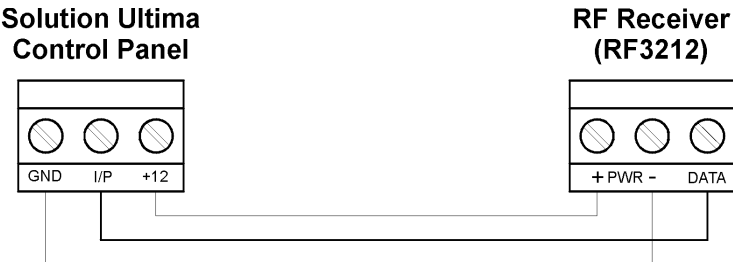
图 1: 无线接收机 (RF3212) 接线图
