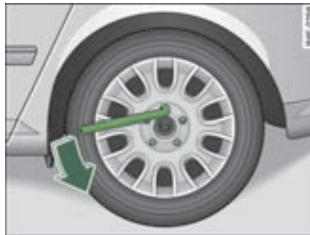
图 314 更换车轮：松开车轮螺栓
