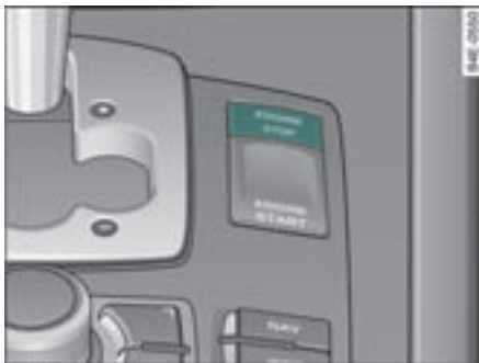
图 169 advanced key（高级钥匙）：STOP 按钮
