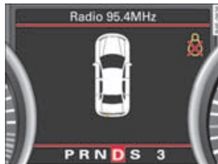
图 15 显示屏：灯泡故障指示灯
