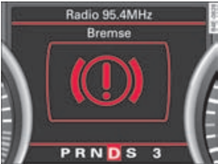
图 18 显示屏：制动系统故障
