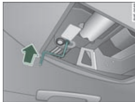
图 59 顶篷局部视图： 用于应急操作的曲柄
