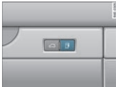
图 280 驾驶员车门：将油箱盖板开锁
