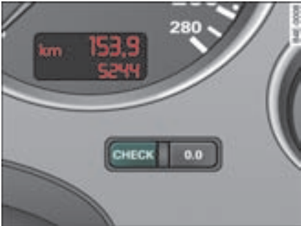
图 17 组合仪表：CHECK（检测）按钮
