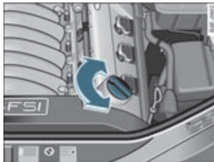
图 292 发动机舱：发动机机油加注口盖板
