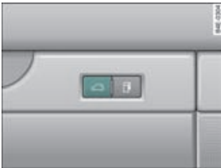
图 43 驾驶员车门：将行李箱盖开锁
