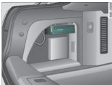
图 140 左侧杂物箱：导航系统的 DVD 播放器
