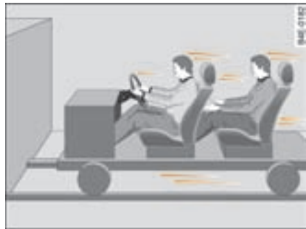
图 237 载有未系安全带乘员的汽车正向墙体驶去
