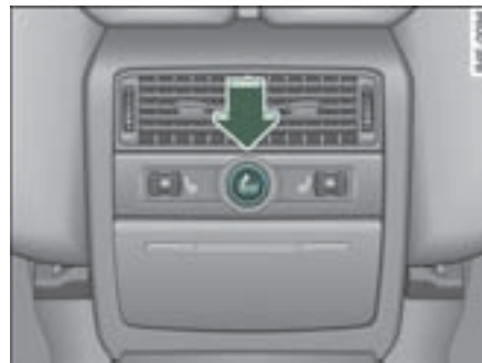
图 125 中控台后部：点烟器
