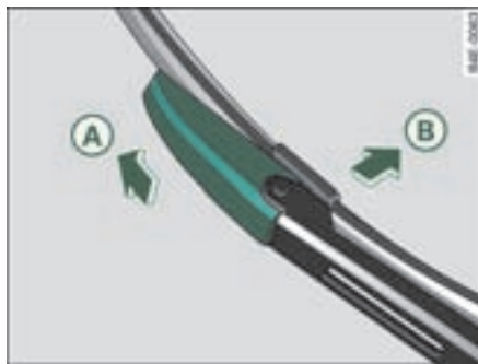
图 83 拆卸车窗玻璃刮水片
