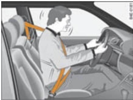
图 236 已系好安全带的驾驶员在突然刹车时被正确系上的安全带拉住。
