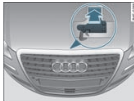
图 285 发动机舱盖下面的拉手
