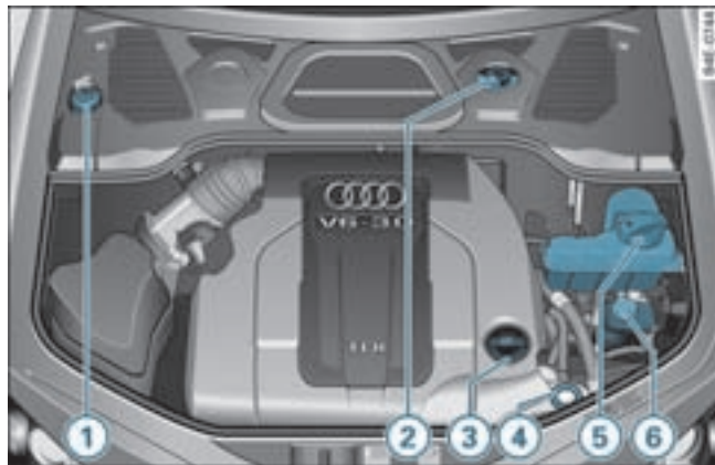
图 288 储液罐、发动机机油油尺和发动机机油加注口的典型布置
