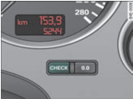
图 5 组合仪表：CHECK (检测) 按钮
