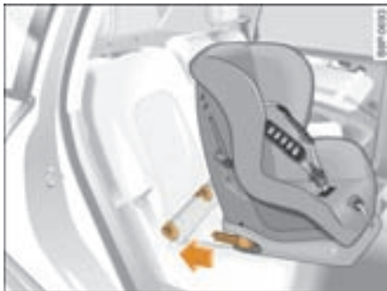
图 266 将 ISOFIX 儿童座椅推向已安装好的锥形套管
