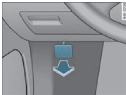
图 284 驾驶员侧脚部空间局部视图：释放手柄
