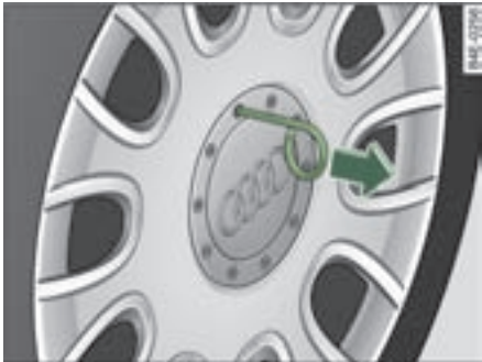
图 312 更换车轮：拉下车轮装饰罩
