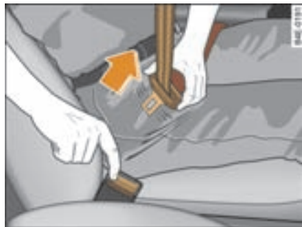
图 247 将锁舌从安全带锁扣中松开
