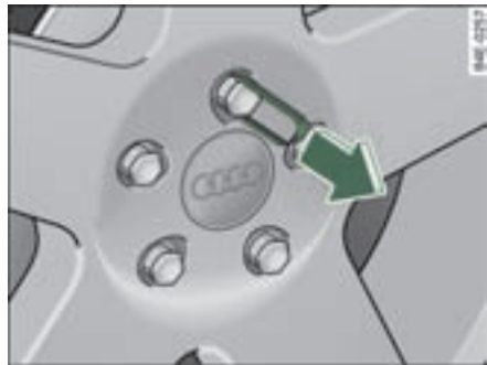
图 313 更换车轮：拆下封盖
