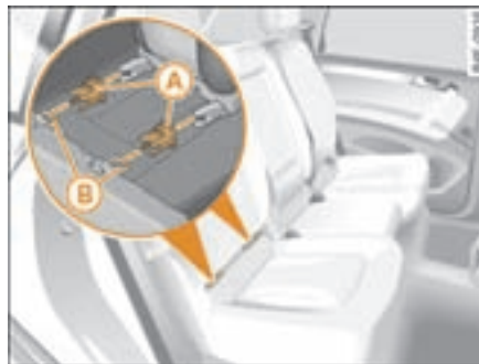
图 265 后座椅靠背和椅面之间用于 ISOFIX 儿童座椅的固定环 (B)
