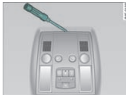
图 58 顶篷局部视图： 螺丝刀的插入点
