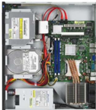
华硕 RS100-E5/PI2 服务器凭借轻薄短小的身材，出色的整体效能，超低的功耗水平和平易近人的价格成为中小企业用户的不二选择。双核至强® 3000 处理器及最新的 45nm 处理器带来的出色运算处理能力，可使 RS100-E4/PI2 轻松胜任包括 Web 服务、邮件服务、FTP 服务、企业 OA 服务等多种应用。额外的磁盘阵列支持，也为企业数据提供的第一道保护措施。
