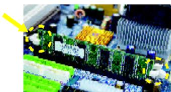
3. 將卡榫向內推，確實卡住記憶體模組 DIMM。一旦固定位置，兩旁的卡榫便自動卡住記憶體模組予以固定。試著輕輕搖動記憶體模組，若不搖晃則裝置成功。
