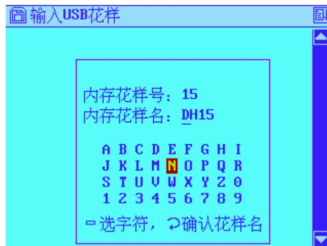
(5) 系统开始花样输入。输入过程中显示输入进度条画面。输入完毕，提示是否继续输入花样，“否”则不继续输入。如果系统处于刺绣准备状态，系统自动转入参数输入操作；如果系统处于刺绣确认状态，系统提示是否改绣新输入花样。
