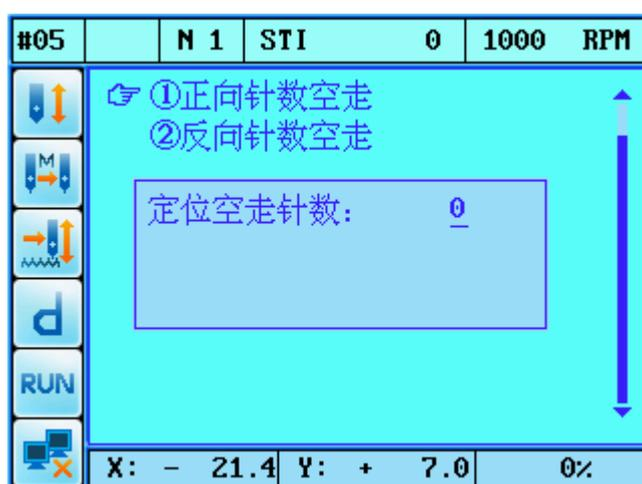
(3)按数字键输入空走针数，再按确认键 “
