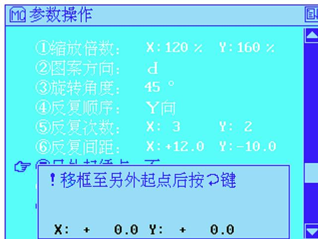
按“ ”键将绣框移至另外起点处后再按“ ”键确认输入结果则画面提示：
