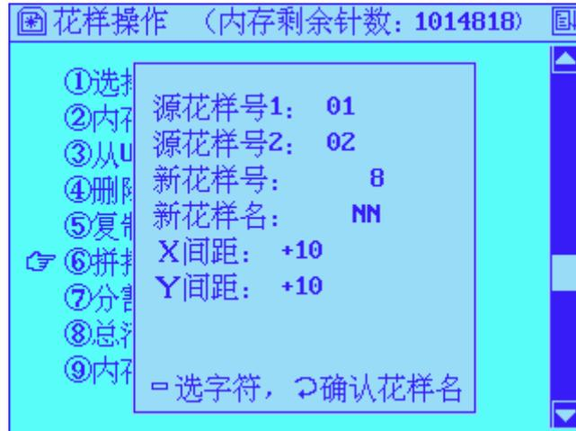
(5) 按数字键输入 X 向间距-999.9~+999.9(mm)。再按“
