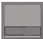
触控板(Touch Pad)是一种触摸敏感的指示设备,它可以实现一般鼠标的所有功能。通过手指在 Touch Pad 上的移动,您能够容易地完成光标的移动。通过按动 Touch Pad 下方的按键,您可完成相应的点击动作(按动左、右键即相当点击鼠标的左、右键)。其中两个 T/P 按键之间有一个 LED 灯,指示灯常亮表示表示触控板处于可使用状态。
