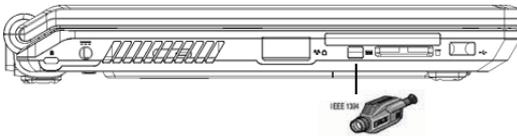
IEEE 1394 是一种 Windows 系统支持的新式输入输出标准，可以保持稳定频率下高速传输数据及数字视频信息。可以连接外部硬盘、数码相机、摄像机等 IEEE 1394 设备。此技术广泛应用于数码相机等消费类产品中。
