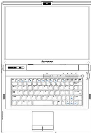
请直接用手扶着笔记本前端的中间部位，慢慢抬起 LCD 面板至 90 度。按一下键盘右上方的电源开关
