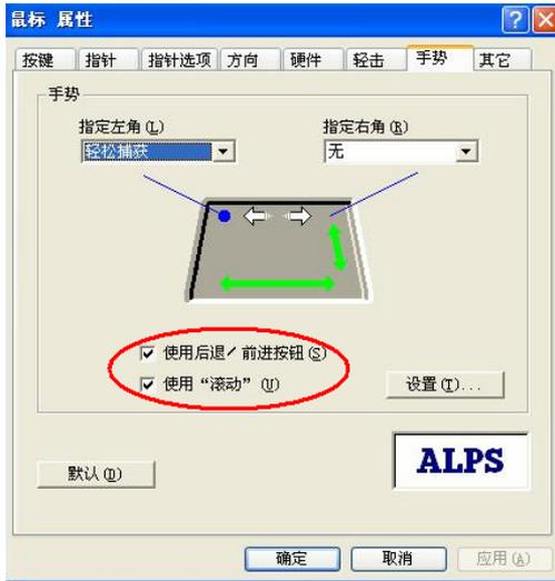
选择“手势”选项, 然后可以看到看到图中“使用后退/前进按钮”以及“使用“滚动””这两个选项默认为“选定”, 可以关闭此两选项, 则关闭隐形触控板上下、左右滚动功能; 当然在控制面板中的鼠标项, 您可调节 Touch Pad 的多种属性, 还可获得更多的帮助和示例。
