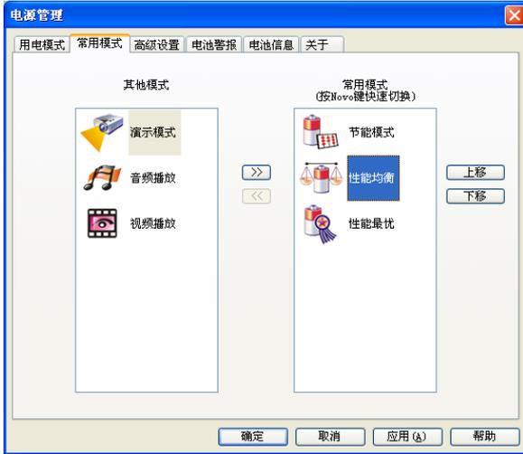
用于设置常用电源模式及其顺序，用户可通过键盘上的 Novo 快捷键在其中进行快速切换。右侧是常用模式，左侧是其他模式，用鼠标双击或点击箭头按钮即可交换模式。常用模式必须至少包含三种电源模式，其顺序可通过“上移”、“下移”按钮设定。
