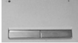
隐形触控板(Touch Pad)是一种触摸敏感的指示设备，它可以实现一般鼠标的功能。通过手指在 Touch Pad 上的移动，您能够容易地完成光标的移动。通过按动 Touch Pad 下方的按键，您可完成相应的点击动作（按动左、右键即相当点击鼠标的左、右键）。其中 T/P 按键上方有左右两个 LED 等，左边的 LED 灯用来控制隐形触控板的打开或者关闭（通过 Fn+Esc 组合键来实现），右边的 LED 灯的亮暗用来表示触控板是否处于使用状态，当使用触控板移动 Cursor 时候，右边蓝色 LED 闪烁，其它情况下 LED 处于关闭状态
