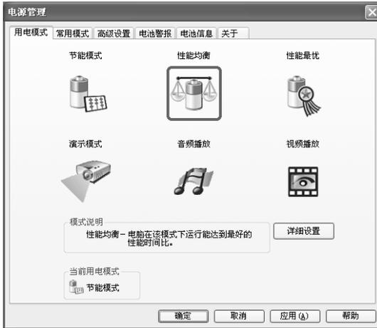
首先点击选择某一电源模式，此时会显示该模式的简单说明。然后点击“详细设置”按钮即弹出该模式的选项对话框。选项划分为显示器和系统选项两部分。所有选项都有两组值，分别适用于外接电源模式和电池模式。
