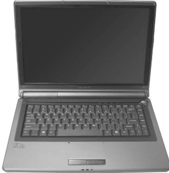
请直接用手扶着笔记本前端的中间部位，慢慢抬起 LCD 面板至 90 度。按一下键盘右上方的电源开关
