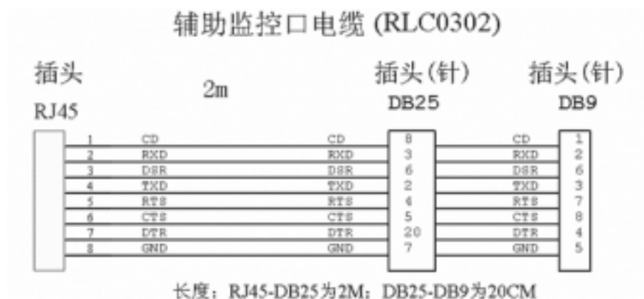
图 3-6 RLC0302 监控电缆内部连线示意图
