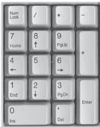
数字键区包括了10个数字键、加减乘除符号、小数点、Number Lock 键和回车键。当 Number Lock 键的灯亮时,数字键区的各个键作为数字键使用;灯不亮时,这些键作为编辑功能键使用。
