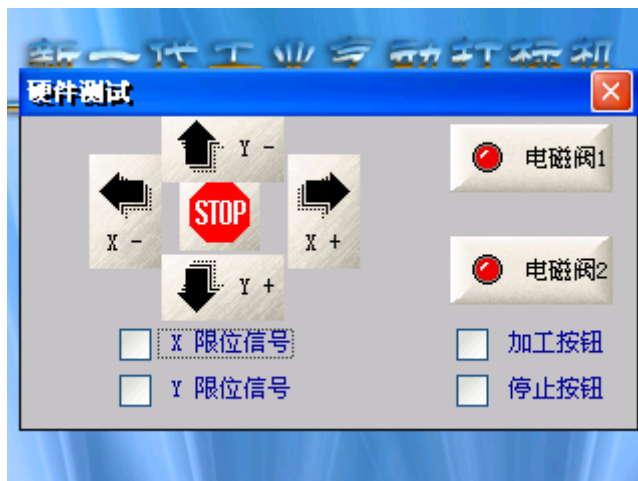
图 3-6 LT7310 控制器硬件测试界面
