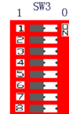
图 3-1 设置波特率的拨码开关 SW3
