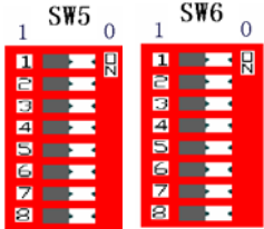
图 4.1 设置开关量报警状态的拨码开关
