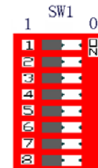
图 3-2 设置地址的拨码开关 SW1
