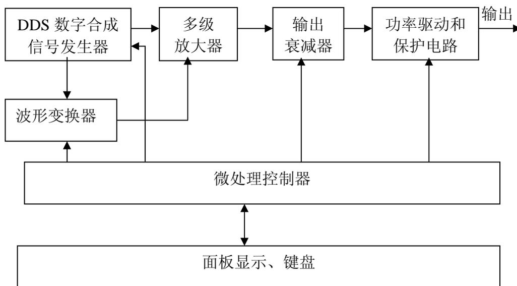
KH1655C 型信号发生器主要由 DDS 数字合成信号发生器、波形变换器、多级放大器、输出衰减器、输出功率驱动器及保护电路、微控制器和键盘扫描、液晶数据显示及电源部分组成。
