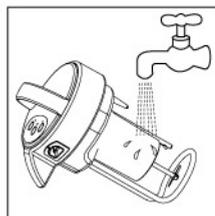
1. 机头：请用水轻轻冲去机头下部粘附的豆浆或其他东西，切勿将机头浸入水中，也不要用水清洗机头上部，以防止机头进水，发生短路现象。
