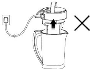
■ 制浆完成后，请不要再二次加热、打浆，否则会造成粘管、糊管。
