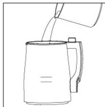
请将水加至上、下水位刻度线之间。（杯体内无水或水位过低，机器自动停止工作，以保证使用安全。）
