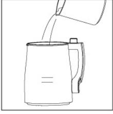
请加水至上、下水位刻度线之间。（杯体内无水或水位过低，机器自动停止工作，以保证使用安全。）
