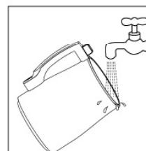
3. 杯体：请用清洁块仔细清洗杯体，将杯体内部清洗干净，以免残留的豆浆产生异味，切忌将杯体底座浸入水中。
