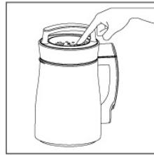
请将机头按正确的位置放入杯体中，插上电源线，指示灯全亮，按果汁功能键，这时果汁功能对应图形指示灯亮，同时启动该功能程序。
