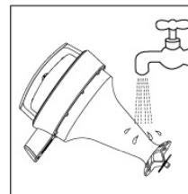
1. 机头：请用水轻轻洗去机头下部粘附的豆浆和其它粘附物，切勿将机头浸入水中，也不要用水清洗机头上部，以防止机头进水，发生短路现象。
