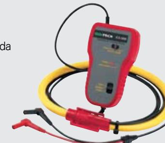
Pinzas amperimétricas de corriente CA/CC para medidas seguras en ausencia de contacto con la corriente.
