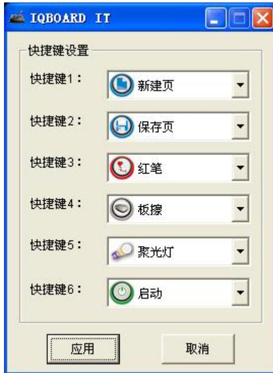
(2) 在快捷键设置窗口中，点击该快捷键相应的下拉框按钮，然后在弹出的下拉菜单中选择您所需要的功能，点击“应用”后即可生效。(如图所示)
