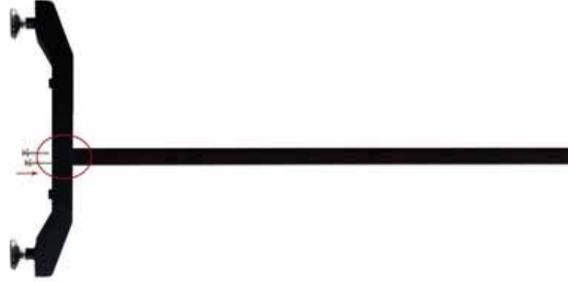
(2) 分别使用一个大头螺丝，将斜撑管的下端固定在每个脚底横管上，如图所示：
