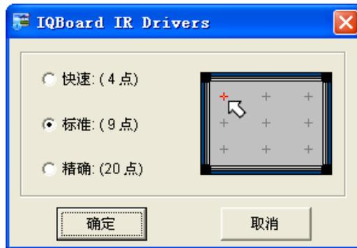
2) 选择定位精度后，点击[确定]按钮，便会出现定位界面，根据定位界面上的箭头指示，用无色书写笔（或手指）点压板面闪烁的红色十字定位框的绿色中心点，如果点压的该点变成绿色，则该点定位成功，下一个定位点变红，箭头同时移至该定位点，整个定位过程是通过无色书写笔（或手指）按箭头提示来顺序点击板面上9个（4个或20个）闪烁交叉点的简单过程。
