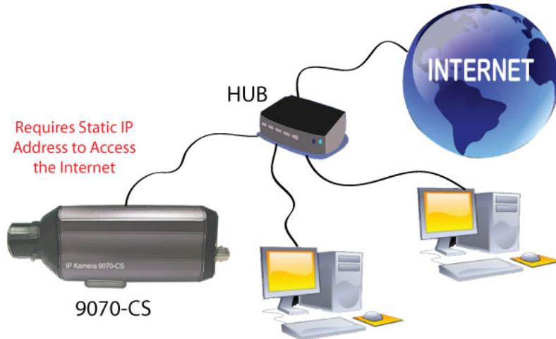
使用上方的網路架設環境情況下，9070-CS 連接至外網是透過 HUB 不是透過 Router 來做撥接，HUB 無法像 Router 可以自動 DHCP 分配 IP 給裝置，因此麻煩聯絡你的申請一組固定 IP Address 此 IP Address 由 ISP 提供。
