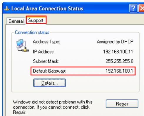
**IP Address:** 請確認 IP Address 的前 3 個 IP 位置與 Default Gateway 的前 3 個 IP 位置是相同的。
