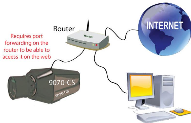
使用上方的網路架設環境情況下，需由 Router 內部開一組端口，port forwarded (映射) 給 IP Kamera 9070-CS 這台機器與外網做聯繫 Port 數。
