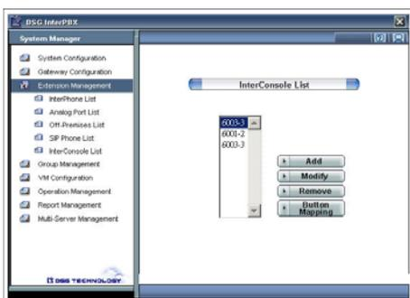
3. 点击Add以新增总机值机台。输入InterConsole的名称, 并选择要连接的分机号码。
