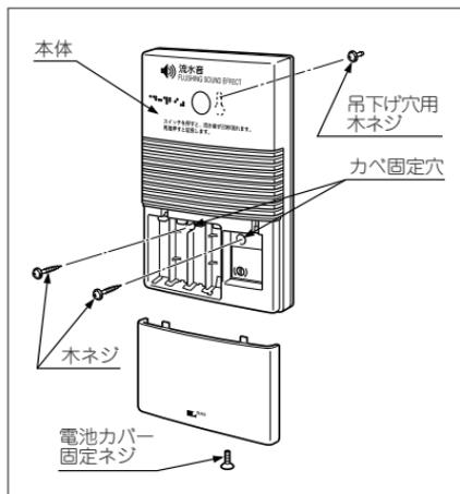
※壁面に2mm以上の段差がある場合、製品裏面にスペーサーを用意するなどして段差をなくしてから施工してください。
