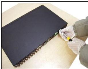
①拆卸主机上盖的固定螺丝
