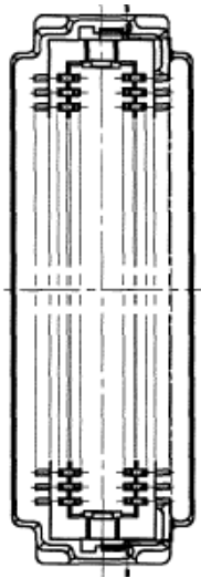
图5-4 MC703 模块使用的连接器 HRS 公司的 DF12(3.0)-60DS-0.5V(86)
