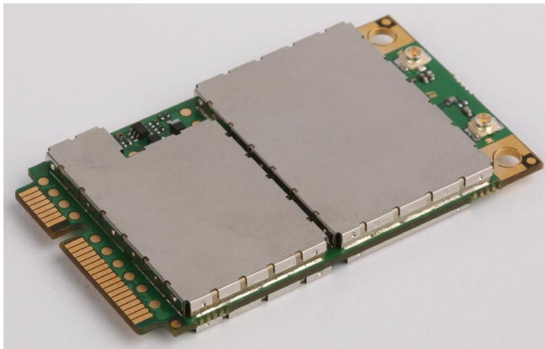
图1-1EM770W UMTS M2M 无线模块外观
