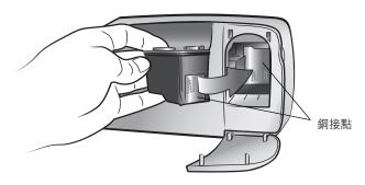
6 將列印墨匣推入列印墨匣托架中,直到您覺得它已鎖至定位為止。
