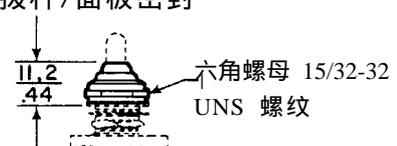
为了与标准拨杆一起使用，拨动开关配有 15/32" 套管。包括一个硅酮橡胶密封罩和胶粘在一个六角螺母上的面板密封。
