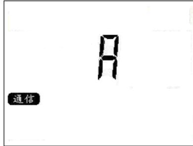
其中，屏幕正中闪烁的字符，代表了目前的通信协议， $A$  代表单机通信， $b$  代表多机 ModBus 通信协议。按  $\triangle$  或者  $\nabla$  可以切换选择。
